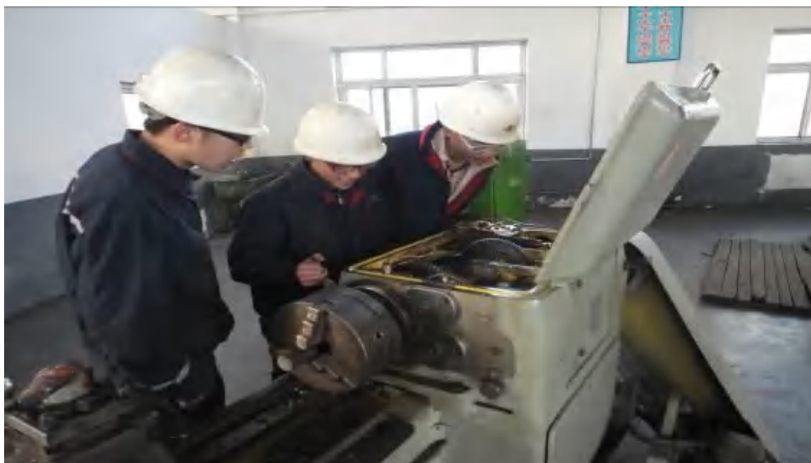
第二课堂活动小组学生对车床构造进行分析学习并就有关故障进行维修。
